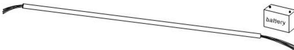
3) Conecte el aerogenerador a los cables y aislar las conexiones utilizando bornas adecuadas, cinta termoretráctil o una cinta aislante de calidad. .
